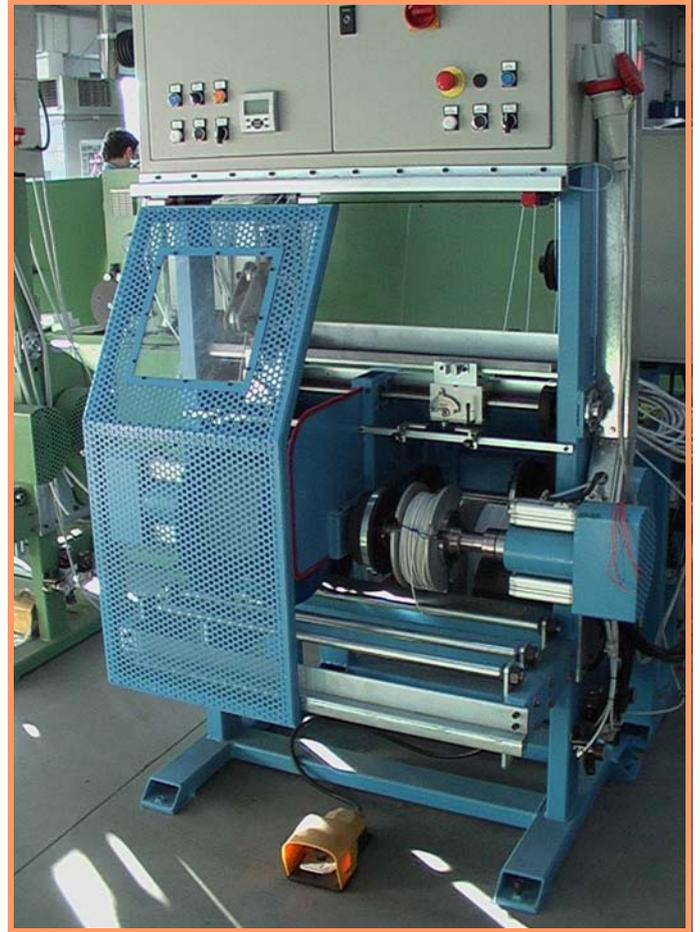
El enrollador tipo “AV 2x400 CA 300” permite el embalaje de bobinas o rollos, con medidas hasta un máximo de: diám.400 x200 para las bobinas y diám. 400x90 para los rollos.
